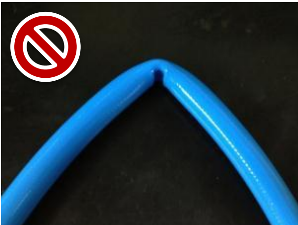
Auswirkung auf die Form eines geknickten Schlauches
