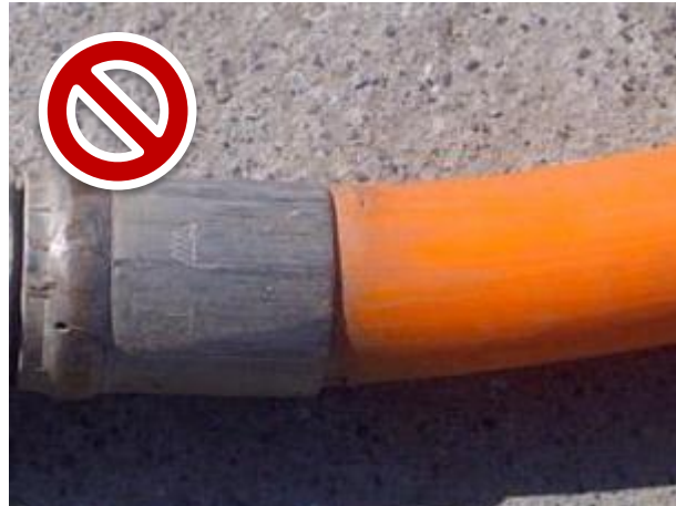
Bilder von Schläuchen die kurz hinter der Armatur geknickt sind
