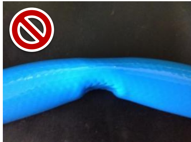
Auswirkung auf die Form eines geknickten Schlauches
