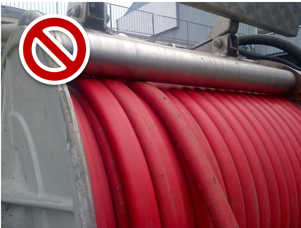
Ein stark beschädigter Schlauch aufgrund einer schlecht eingestellten Führung am Fahrzeug
