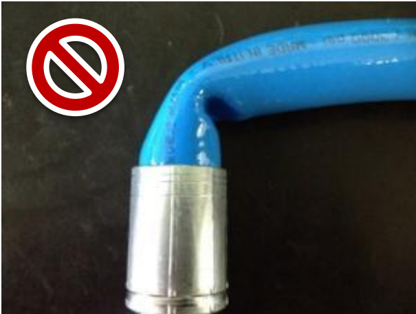
Bilder von Schläuchen die kurz hinter der Armatur geknickt sind
