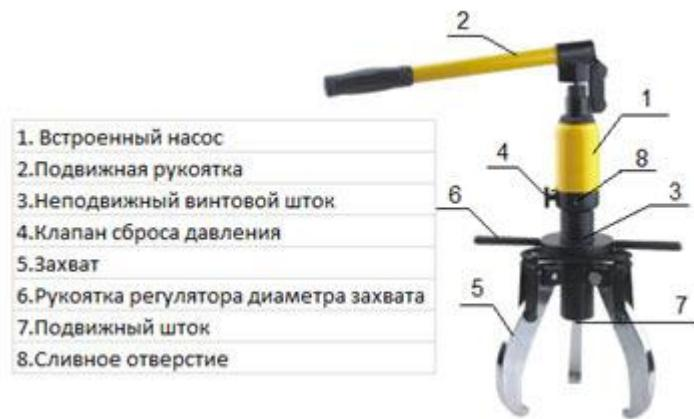
3.1. Лапы съемника 5 крепятся на подвижном основании и соединены серьгами с регулировочной гайкой с рукоятками 6. Вращением гайки с рукоятками 6 настраивается диаметр захвата, а вращением гидроцилиндра настраивается глубина захвата.
